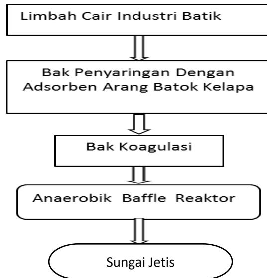
Gambar 2. Diagram alternatif pengolahan limbah cair industri Batik Jetis Sidoarjo.
